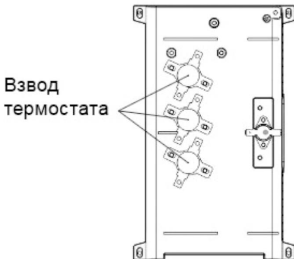
Рис. 22. Ручное восстановление термостатов
